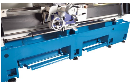
Des ergots de butée réglables permettent d'arrêter automatiquement l'avance
